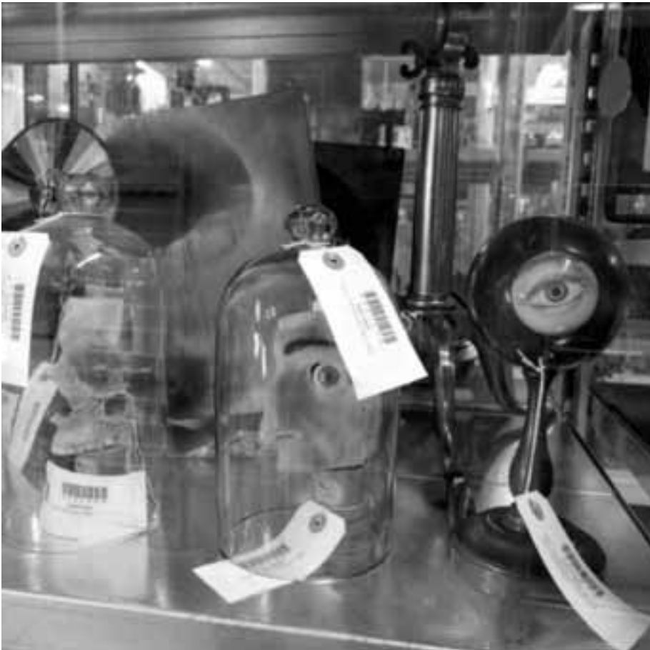
Cabinet de Charles. Au premier plan, œil artificiel montrant les causes de la myopie et de la presbytie. Au deuxième plan, appareil à roues dentées pour faire mouvoir des plans circulaires diversement colorés © Musée des arts et métiers/P. Dolémieux/Métis
